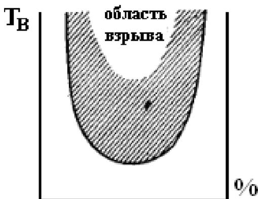
Рисунок 17 - Зависимость температуры воспламенения от процентного состава смеси при постоянном давлении
