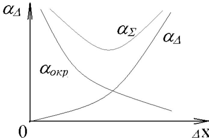
Рис. 4. Схематичный рост ошибок аппроксимации и округления
