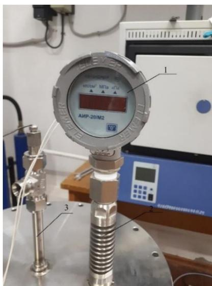
*1 – цифровой датчик давления; 2 – охладитель для датчика давления; 3 – штуцер ввода ТН в ЭМУ*
