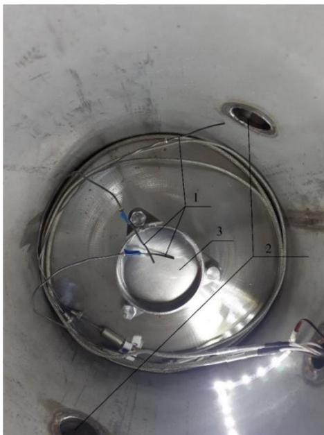
*1 – мобильный датчики температуры (термопара); 2 – смотровое окно; 3 – ёмкость для МЖ*
