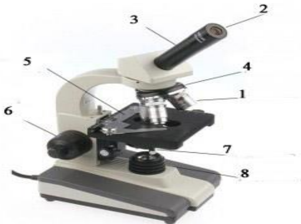
6-сурет. Микроскоптың жалпы құрылысы: 1-объектив, 2-окуляр, 3-тубус, 4-револьвер 5-үстелше, 6-реттеуші винт, 7- конденсатор, 8-жарық
