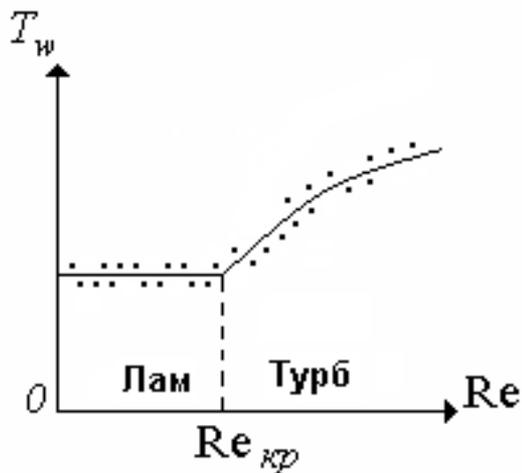
Результаты измерения собственной температуры плоской пластины при её обтекании в продольном направлении для разных чисел  $Re$ .
