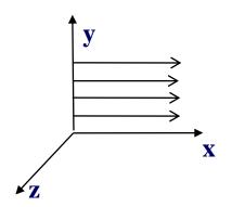
Слоистые течения - это движение жидкой или газовой среды, при котором жидкость или газ движутся слоями параллельными друг другу. При этом сохраняется лишь одна составляющая скорости, а остальные две равны нулю:  $\upsilon(u,0,0)$
