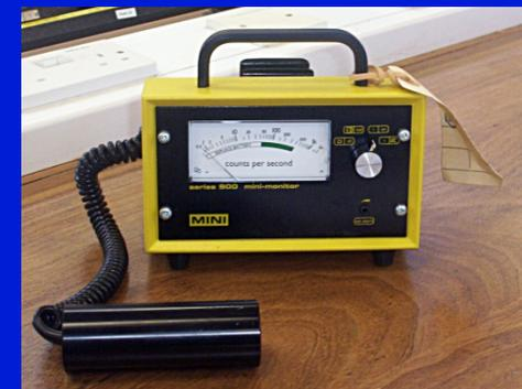
Радиометр, чувствительный элемент — счётчик Гейгера — расположен в выносном блоке на переднем плане.
