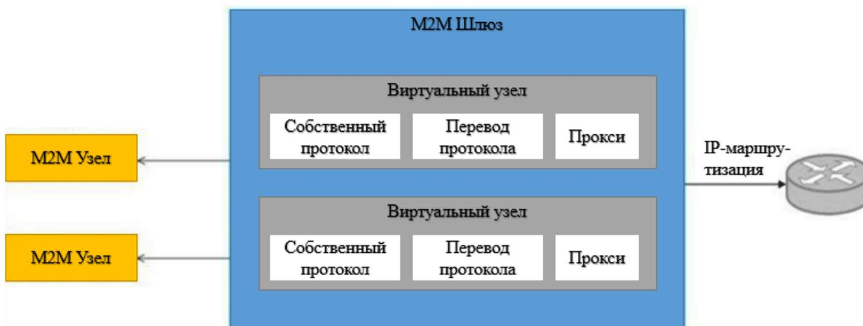
Рисунок 5.2. Блок-схема M2M-шлюза
